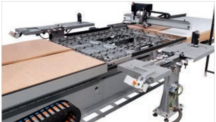
Almacén revólver de 12 posiciones en el cabezal y 12 posiciones a bordo del carro X que minimiza los tiempos de ciclo.
