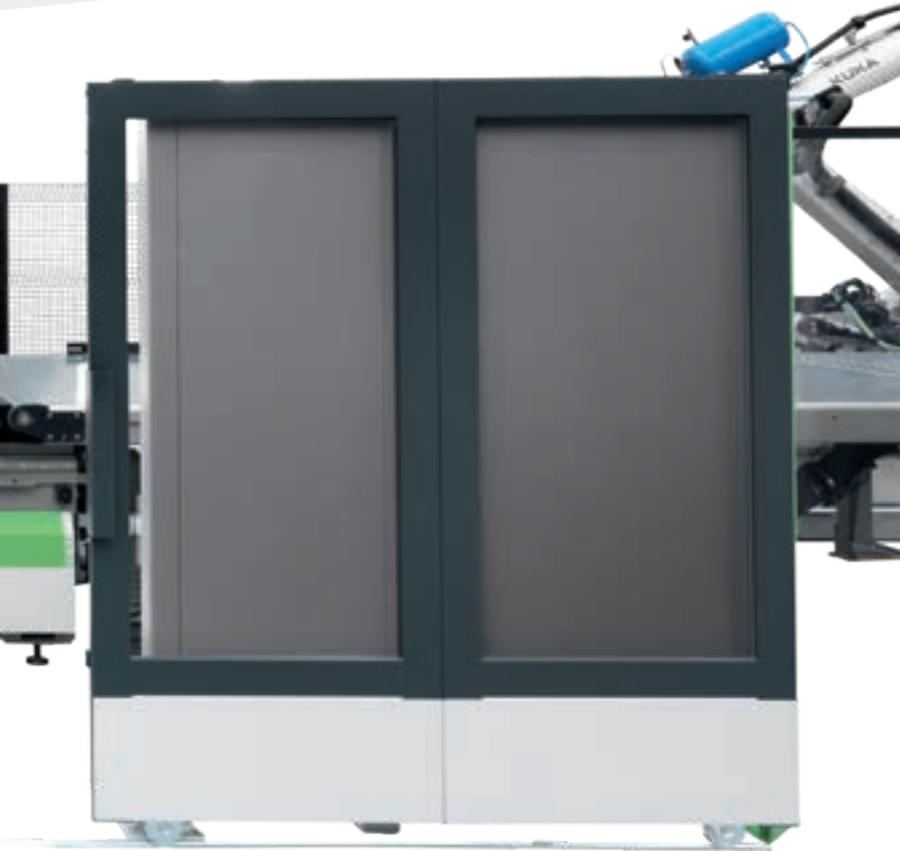
La cabina que encierra la máquina lleva puertas que pueden abrirse completamente por la parte delantera para facilitar las operaciones manuales. Las grandes ventanas de inspección ofrecen una visibilidad inmediata para establecer un contacto directo entre el operador y la máquina.
