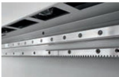
Las guías de cremallera sobredimensionadas para el desplazamiento a lo largo de los ejes X e Y, que sirven para obtener la máxima velocidad y aceleración dentro de su categoría, le dan a la máquina una gran estabilidad en los movimientos aumentando el nivel de precisión y calidad del mecanizado.
